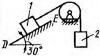
Определить наименьший вес тела 1, при котором оно скользит вниз по плоскости  $DE$ , если вес груза 2 равен 320 Н, коэффициент трения скольжения между телом 1 и плоскостью  $DE$  равен 0,2. (979)
