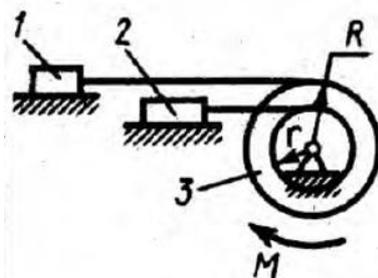
Определить угловое ускорение барабана 3, если его момент инерции относительно оси вращения  $I_3 = 0,1$  кг · м<sup>2</sup>, момент пары сил, действующей на барабан,  $M = 0,6$  Н · м, массы тел  $m_1 = m_2 = 10$  кг, радиусы  $R = 0,2$  м,  $r = 0,1$  м. (1)
