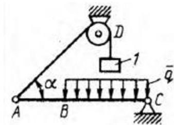
Балка  $AC$  закреплена в шарнире  $C$  и поддерживается в горизонтальном положении веревкой  $AD$ , перекинутой через блок. Определить интенсивность распределенной нагрузки  $q$ , если длины  $BC = 5$  м,  $AC = 8$  м, угол  $\alpha = 45^\circ$ , а вес груза  $1$  равен  $20$  Н. (9,05)
