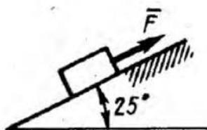
Тело массой  $m = 200 \text{ кг}$  из состояния покоя движется вверх по гладкой наклонной плоскости под действием силы  $F = 1 \text{ кН}$ . Определить время, за которое тело переместится на расстояние  $8 \text{ м}$ . ( $4,33$ )
