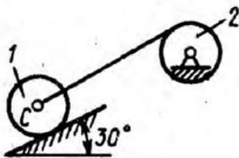
Определить ускорение центра  $C$  катка 1, если тела 1 и 2 – однородные сплошные цилиндры с одинаковыми массами и радиусами. (2,45)
