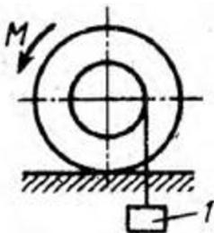
К однородному катку, малый радиус которого 0,2 м, подвешен груз 1 весом 200 Н и приложена пара сил с моментом  $M = 57,6 \text{ Н} \cdot \text{м}$ . Определить в кН наибольший вес катка, при котором он будет катиться влево, если коэффициент трения качения  $\delta = 0,008 \text{ м}$ . (2,0)
