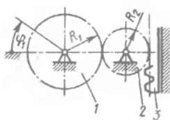
Зубчатое колесо 1 вращается согласно закону  $\varphi_1 = 4t^2$ . Определить ускорение рейки 3, если радиусы зубчатых колес  $R_1 = 0,8$  м,  $R_2 = 0,4$  м. (6,4)
