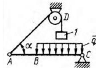
Балка  $AC$  закреплена в шарнире  $C$  и поддерживается в горизонтальном положении веревкой  $AD$ , перекинутой через блок. Определить интенсивность распределенной нагрузки  $q$ , если длины  $BC = 5$  м,  $AC = 8$  м, угол  $\alpha = 45^\circ$ , а вес груза  $I$  равен 20 Н. (9,05)
