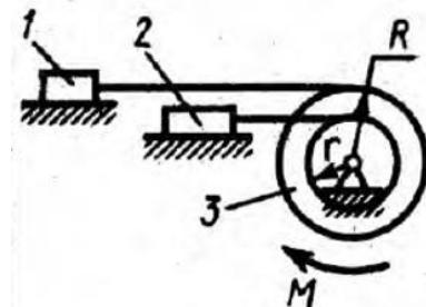
Определить угловое ускорение барабана 3, если его момент инерции относительно оси вращения  $I_3 = 0,1 \text{ кг} \cdot \text{м}^2$ , момент пары си, действующей на барабан,  $M = 0,6 \text{ Н} \cdot \text{м}$ , массы тел  $m_1 = m_2 = 10 \text{ кг}$ , радиусы  $R = 0,2 \text{ м}$ ,  $r = 0,1 \text{ м}$ . (1)
