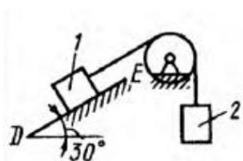
Определить наименьший вес тела 1, при котором оно скользит вниз по плоскости DE, если вес груза 2 равен 320 Н, коэффициент трения скольжения между телом 1 и плоскостью DE равен 0,2. (979)
