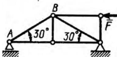
Определить усилие в стержне  $AB$ , если сила  $F = 346$  Н. (-200)
