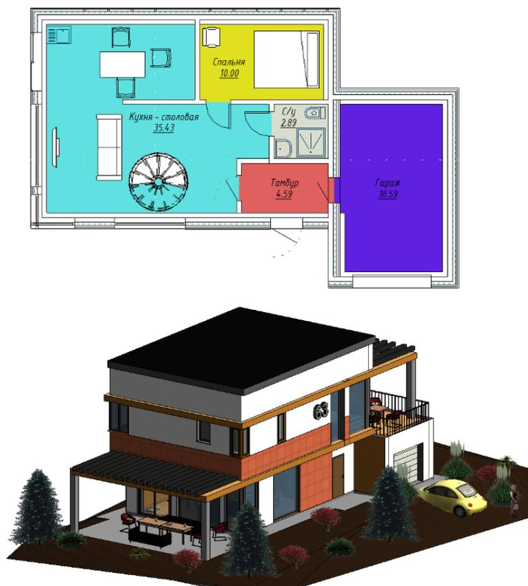
Рисунок 1 – План 1-го этажа и 3D вид малоэтажного жилого здания
