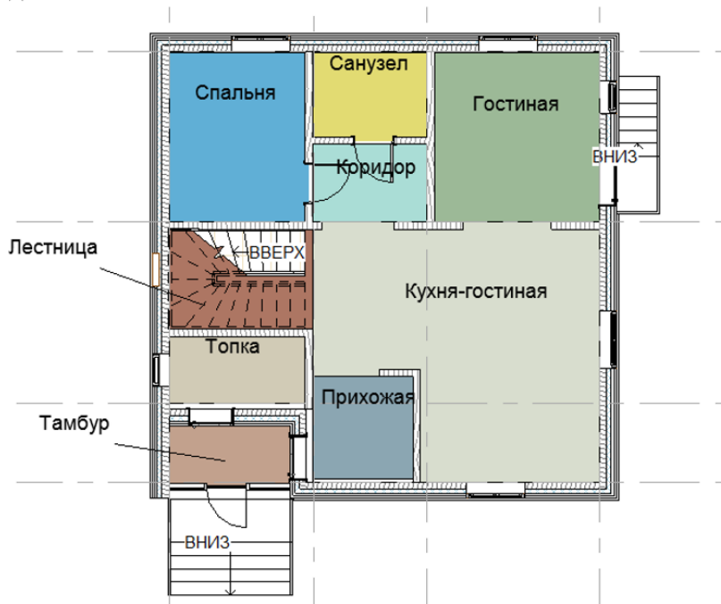
Рисунок 1 – План 1-го этажа малоэтажного жилого здания
