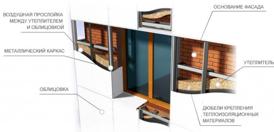
Рисунок 1 – Схема вентилируемого фасада
