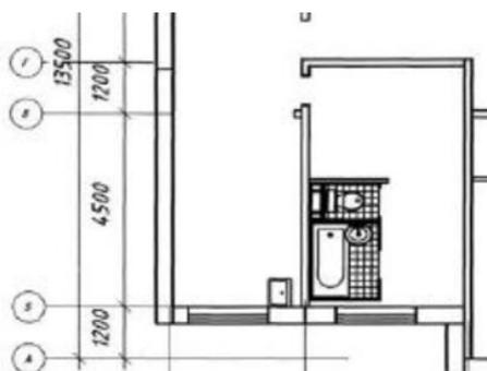
Для заданного фрагмента 9-ти этажного здания разработайте проектное решение и выполните рабочий чертёж схемы холодного водоснабжения.
