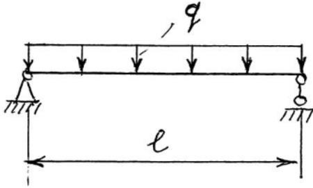
Пролет балки  $l = 5$  м.
