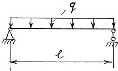
Пролет балки  $l = 6$  м.
