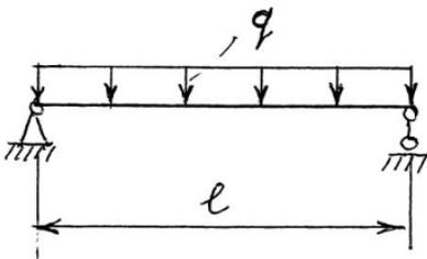
Пролет балки  $l = 6$  м.
