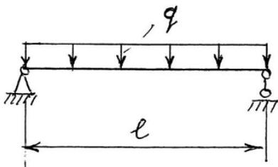
Пролет балки  $l = 5$  м.
