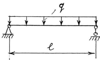
Пролет балки  $l = 6$  м.
