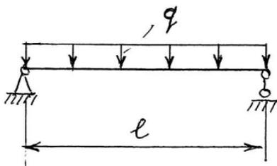
Пролет балки  $l = 4$  м.
