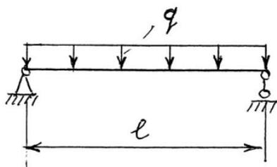
Пролет балки  $l = 5$  м.
