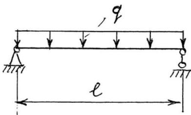
Пролет балки  $l = 6$  м.
