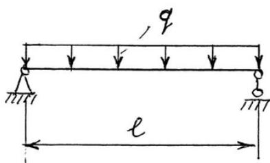
Пролет балки  $l = 6$  м.
