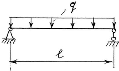
Пролет балки  $l = 3$  м.
