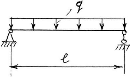
Пролет балки  $l = 5$  м.
