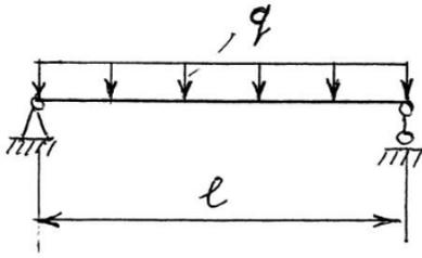
Пролет балки  $l = 5$  м.
