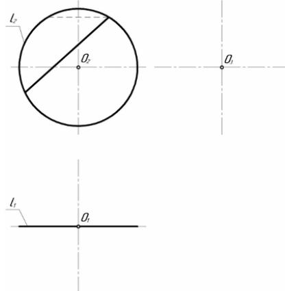
*5.Применяя естественнонаучные и/или общеинженерные знания для решения задач, построить линию пересечения поверхности с плоскостью, определить форму плоских сечений поверхности вращения (цилиндра, конуса, сферы), построить три проекции тела с вырезом.*
