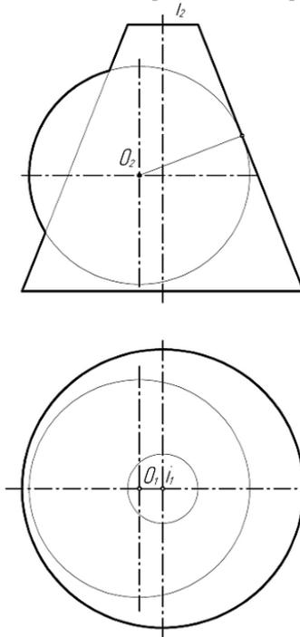
2. Применяя естественнонаучные и/или общинженерные знания для решения задач, построить линию пересечения поверхностей методом секущих сфер, обозначить опорные точки, определить очерки поверхностей.
