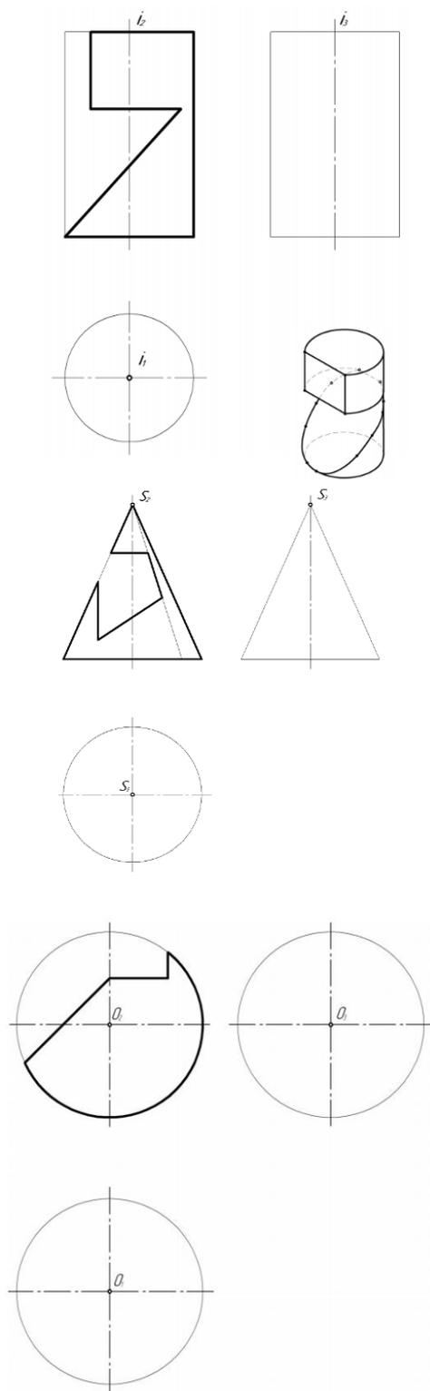
6. Применяя естественнонаучные и/или общинженерные знания для решения задач, построить линию пересечения поверхностей методом проецирующего образа, обозначить опорные точки, определить очерки поверхностей.
