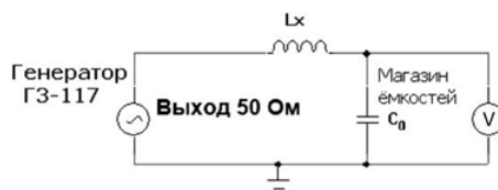
Рисунок – Принципиальная схема для измерения индуктивности
